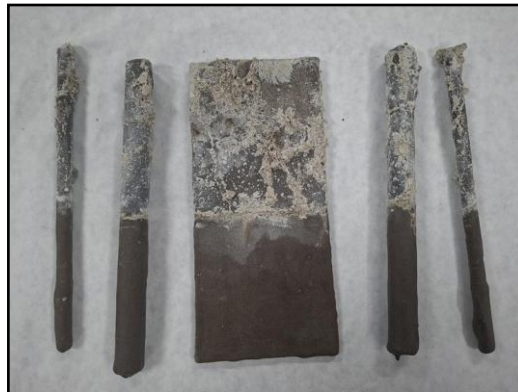
Fotografía nº3: Estado de las barras y placas de acero tras el envejecimiento y sin revestimiento
